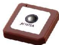
JCJZ1240 外型尺寸 SIZE 12×12×4mm 频率 FREQUENCY 1561- 1610MHz
