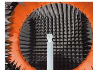
小型微波暗室 Small Microwave Anechoic Chamber
